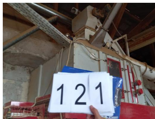
121-Dozator hladnjaka-pužni transporter
