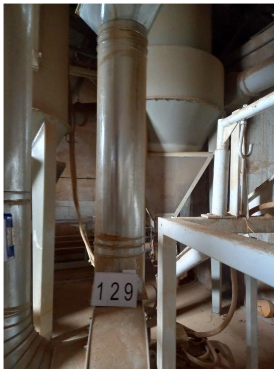
129-Cjevovod aspiracije, fi 250 mm
