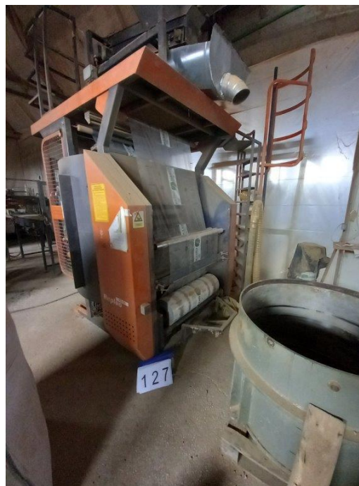
127-Automatski stroj za pakiranje Kogler (automatskopakiranje u vreće, slaganje na paletu te umotavanje strech folijom, kapaciteta 5 t/h)
